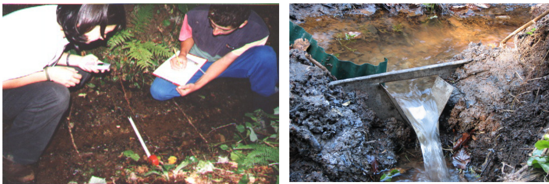
2. kép: Vízhozammérés úszókkal balról és bukóval jobbról (saját fotó)
