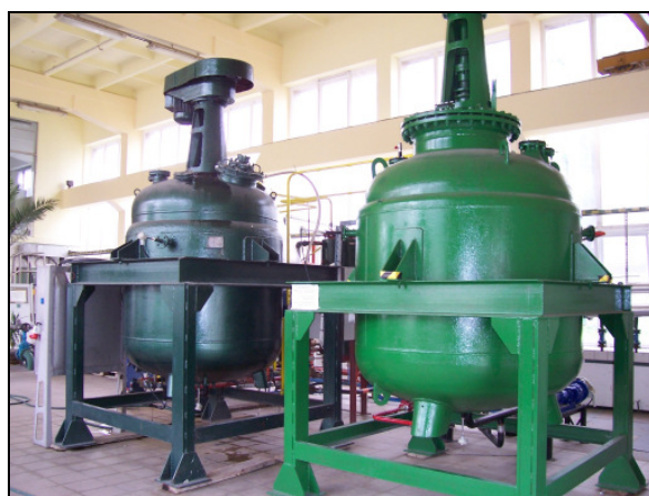
1. kép. A félüzemi reaktorok (Dél-pesti Szennyvíztisztító Telep, Budapest, FCSM Zrt.)
