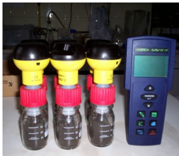
1. ábra. A kis mérőedényes légzésmérő rendszer felépítése
