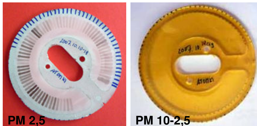
1. ábra. 2007. október 10-19. között streakerrel gyűjtött aeroszol minta. A szűrő- és impaktorfelületet 3 óránként léptettük. Szívósebesség 1 l/perc volt.
