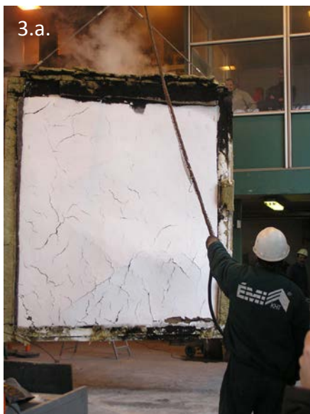
3.a. ábra. Vakolt szalmabála fal tűztesztje az ÉMI Szentendrei Laboratóriumában (2008) 3.b. ábra. A tűzmentett oldal felületi hőmérsékletnövekedésének alakulása a tűzteszt során
