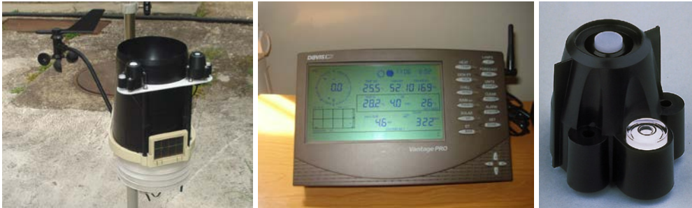
5. ábra. A meteorológiai paraméterek mérésére használt DAVIS Vantage PRO típusú mikrometeorológiai állomás kültéri egysége, beltéri egysége, és a napsugárzás mérésére szolgáló érzékelő.
