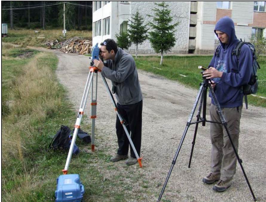
7. ábra. A terepi mérés lézeres mérőállomással, valamint magasságmérővel a biharfüredi mintaterületen.
