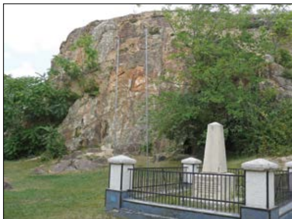
Nadap: az 1888-ban felállított ún. szinezési ősjel ma az országos térképészeti (geodéziai) főalappont. Eredetileg az Adriai-tenger Triesztnél 1875-ben mért átlagos vízszintjéhez igazították a térképezést. A háttérben lévő szikla tetején van a hazai GPS alappont is. (2019. július)
