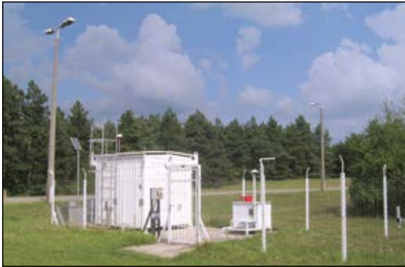
Paks: az atomerőmű körül kiépített lég- és csapadékszenyeződés mérő állomáshálózat egyik tagja (2020. augusztus)
