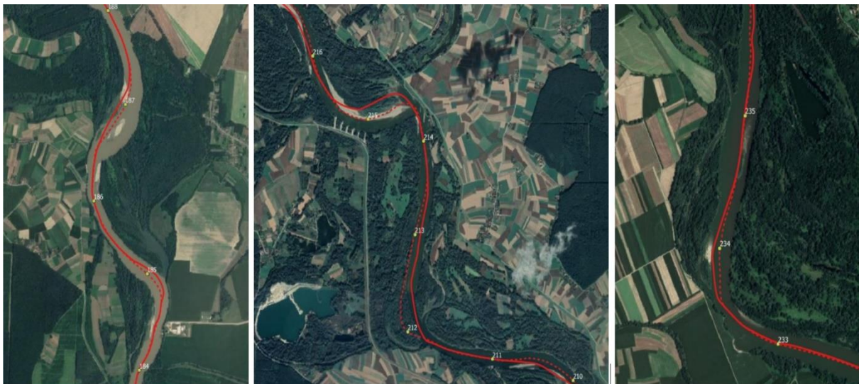
6. ábra. Folyó tengelyvonalának eltérése a 2013-14 (folytonos vonal) és a 2019-es felmérések (szaggatott vonal) alapján, a) 184 – 188 fkm, b) 209 – 219 fkm, c) 233 – 234 fkm.
