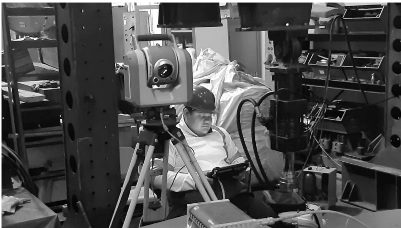
5. ábra Trimble SX10 Robot 3D-szkenner mérőállomás monitoring közben
