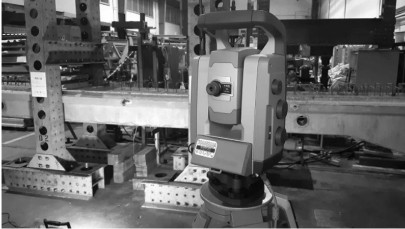
4. ábra Trimble S8 Robot mérőállomás monitoring közben
