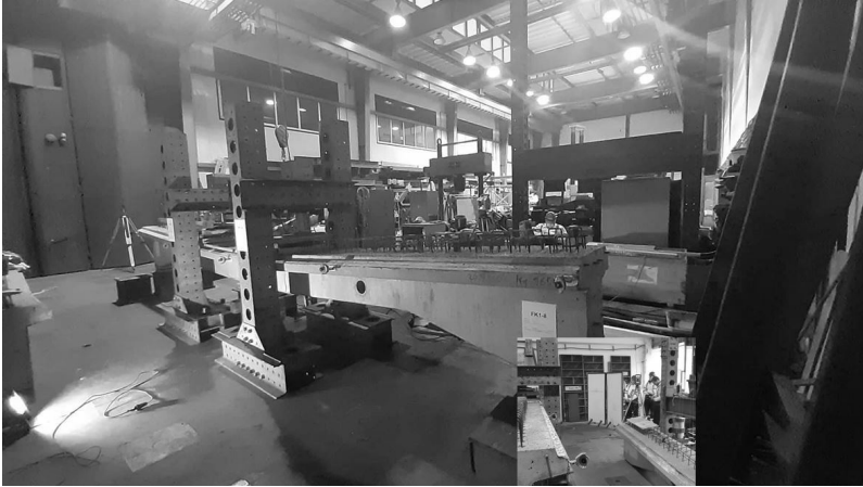
3. ábra 8 m-es gerenda a laboratóriumi terhelő berendezésben
