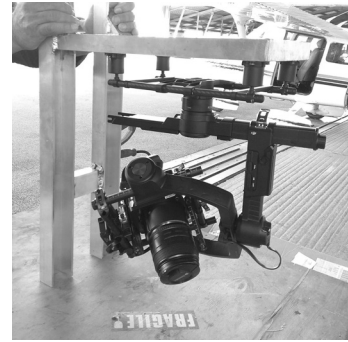
1. ábra A felmérés során használt kamera és tartószerkezete a gimballal
